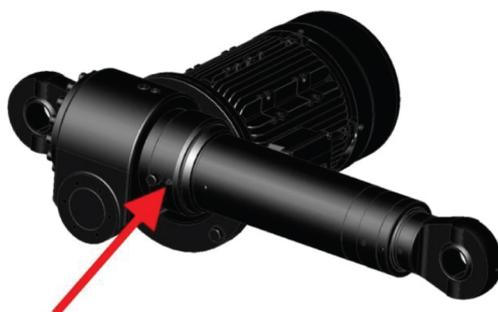
Lubrificare il cilindro elettromeccanico attraverso il nipplo, corsa di circa 100 g/1000 mm. Non utilizzare una quantità di grasso superiore a quella consigliata.
